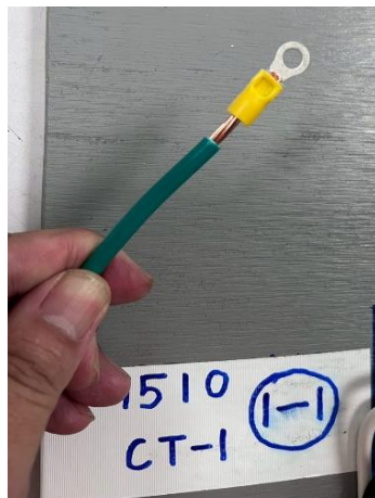
圖 7 剝線太長使銅線裸露
