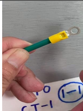
圖 6 銅線末端未超出套管頂部
