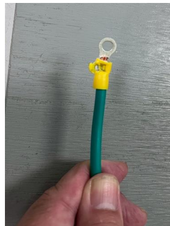
圖 8 壓接端子壓接不良(絕緣套管破裂)
