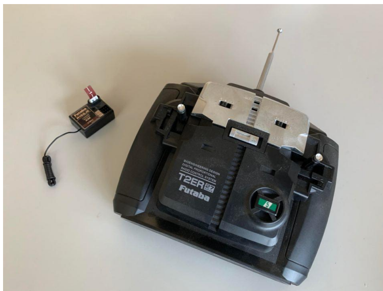
市售 3 通道 27MHz 板型遙控收發器
