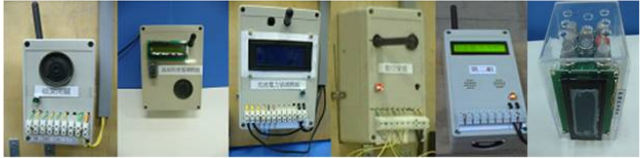
接點輸入模組 溫濕照模組 交流電力模組 家電控制模組 瓦斯模組 氣體模組 圖 4-5
